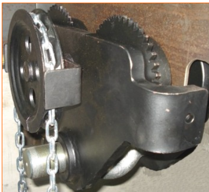
Кошка КМ-5,0Б грузоподъемность 5,0 тонн
