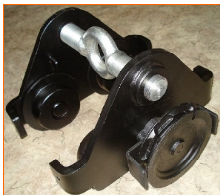
Кошка KM-3,2Б грузоподъемность 3,2 тонны
